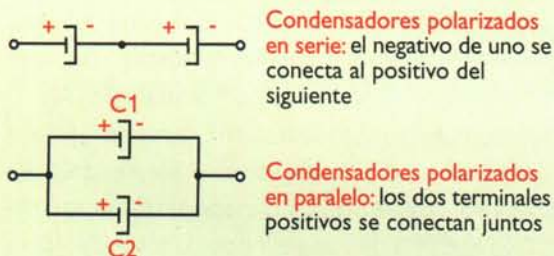
Figura 11.9. Reglas para la conexión de condensadores polarizados en serie y en paralelo
